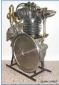
Da nach 1918 die Produktion der Flugmotoren in der MO nicht mehr erlaubt war, suchte man in der Motorenfabrik Oberursel ein Nachfolgeprogramm. Der Obergeringenieur und Chefentwickler der Flugmotoren, Eduard Freise begann mit der Entwicklung eines kleinen Fahrradhilfmotors, dem kleinen GNOM. Der Bausatz konnte von jedermann in schon vorhandene Fahrräder eingebaut werden.
