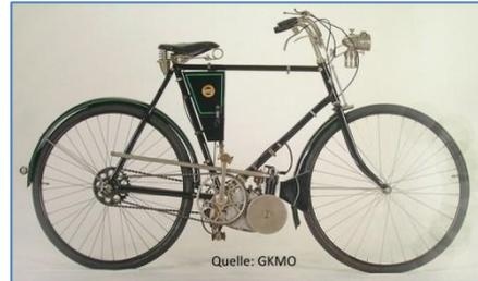
Eduard Freise begann mit der Entwicklung eines kleinen Fahrradhilfmotors, dem kleinen GNOM. Der Bausatz konnte von jedermann in schon vorhandene Fahrräder eingebaut werden.
