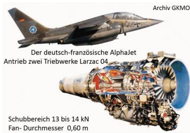
Abbildung 6: Das Triebwerk Larzac 04
