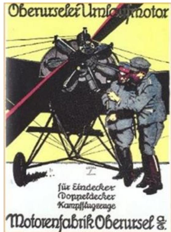
Abb. 4: Fokker- Jagdflugzeug mit Oberurseler Siebenzylinder 80 PS Umlaufmotor U 0
