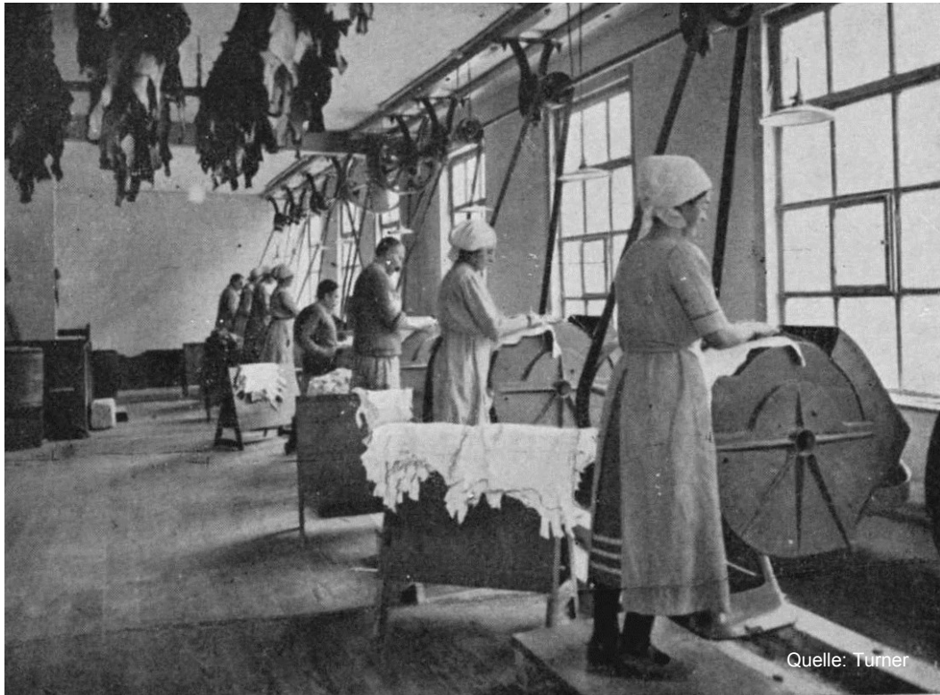
Turner Maschinen im Einsatz Stollräder zum Erweichen der Leder
