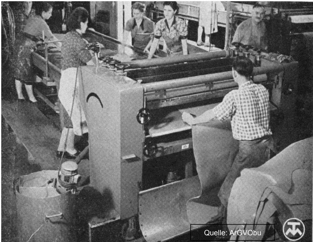
Abretier- und Färbemaschine mit Transportband. Arbeitsbereich 1600 mm
