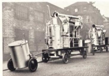
Dämpfkolonne Fig. 12 auf Transportwagen mit Eisenrädern
