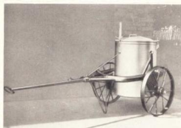
Dämpfpaß Fig. 4 auf Hubwagen Fig. 105/1 mit Eisenrädern
