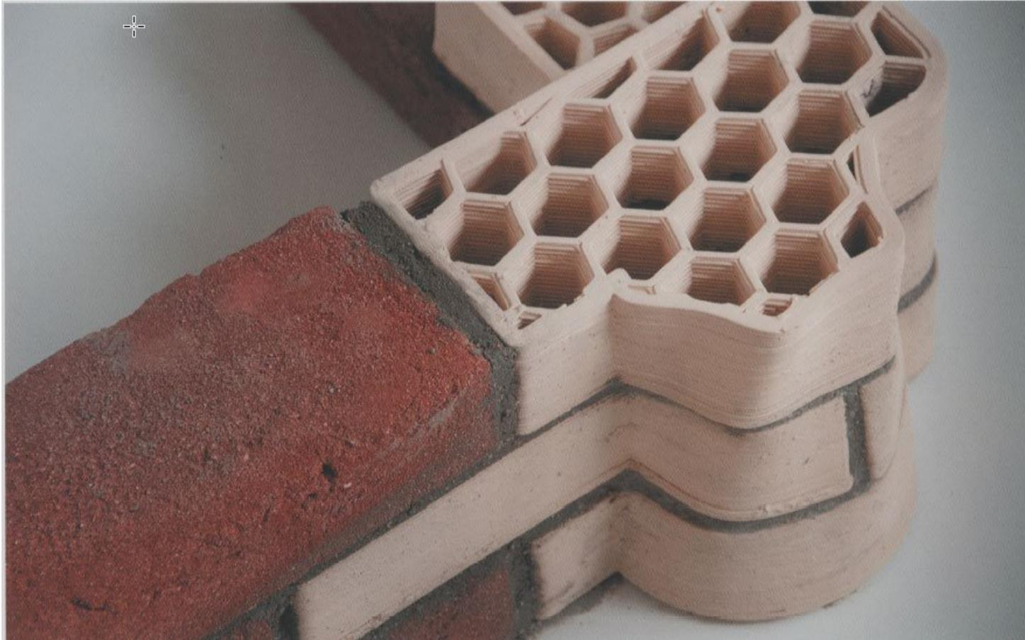
„Gedruckte“ Unipor-Mauerziegel sind Sonderanfertigungen, die etwa aufgrund ihrer Geometrie bestimmte Funktionen im Gebäudebau übernehmen können.
