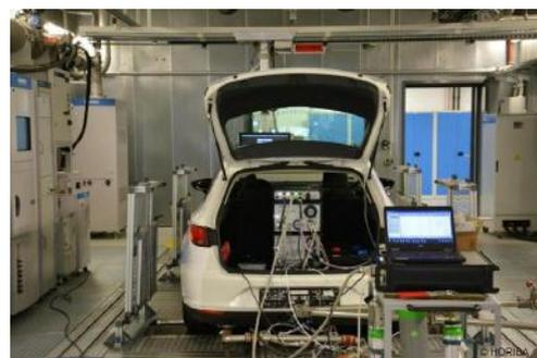
Testfahrzeug auf dem Rollenprüfstand
