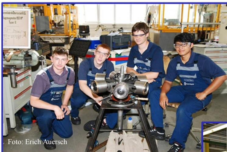
Die Kolben und die Einlassventile sind eingebaut.
