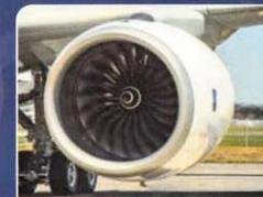
Die Rolls-Royce Trent XWB Antriebe des Airbus A350 sind die effizientesten Großtriebwerke der Welt. Sie tragen entscheidend dazu bei, dass der Kraftstoffverbrauch und somit die CO<sub>2</sub> Emissionen des Flugzeuges im Vergleich zur Vorgängergeneration um rund 25 Prozent reduziert wird.
