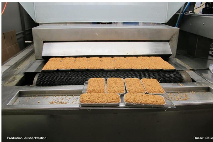
Anschließend in der Ausbackstation ausgebacken.
