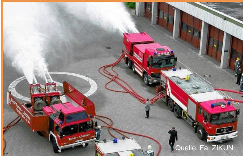
Zwei Turbolöcher im Einsatz. Links Turbol. 1 rechts der weiterentwickelte Turbol. 2.
