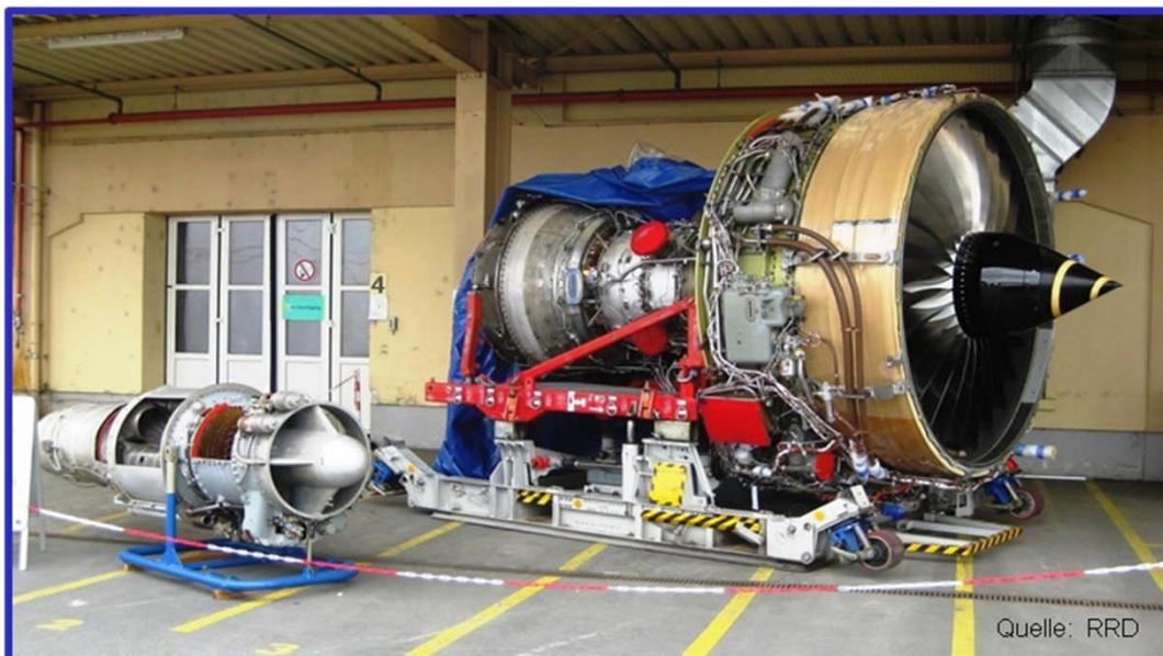
50 Jahre Triebwerksentwicklung links das Orpheus-Triebwerk
