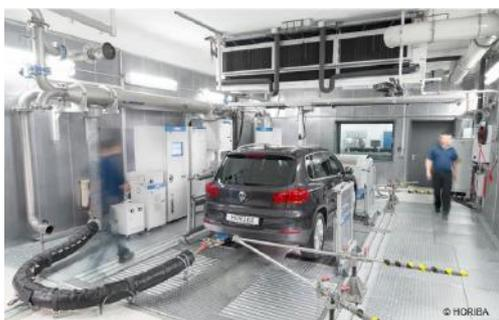
Testfahrzeug auf dem Rollenprüfstand
