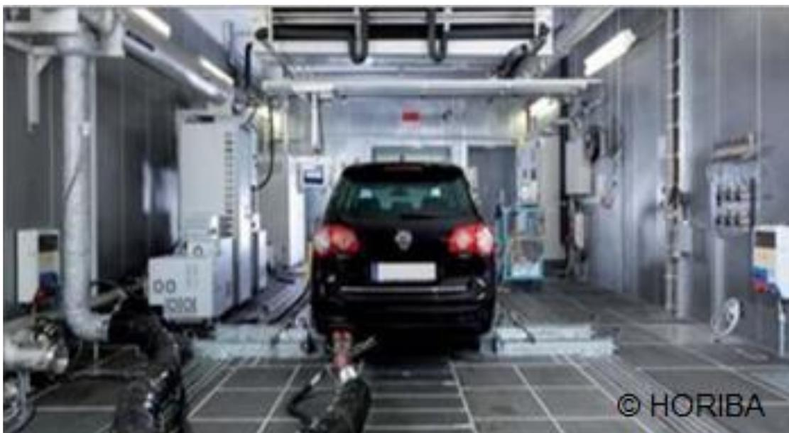
PKW auf dem neuen Rollenprüfstand
