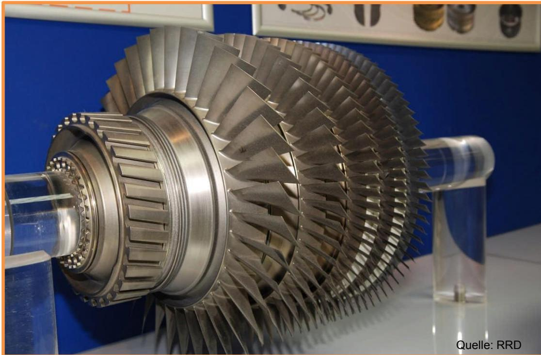
Hochdruckverdichter für das Triebwerk **BR-725**.
