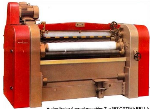
Hydraulische Ausreckmaschine Typ 357 OPTIMA RELLA Arbeitsbreiten: 1500 mm, 1800 mm für alle Kleintierfellarten sowie Kalbfelle und leichte Hälfen
