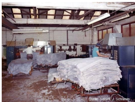
Hydraulische Universal-Falzmaschine Typ 722 D Arbeitsbreite: 1800 mm für ganze Hute, Schweinhute, Halfen und Croupons, mit Nachstellautomatik und Einfahrsicherung
