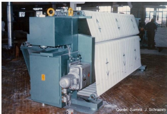
Hydraulische Durchlauf-Vibrations-Stollmaschine Typ 530 Arbeitsbreiten: 1600mm, 2400mm, 3200mm geeignet für alle Lederarten
