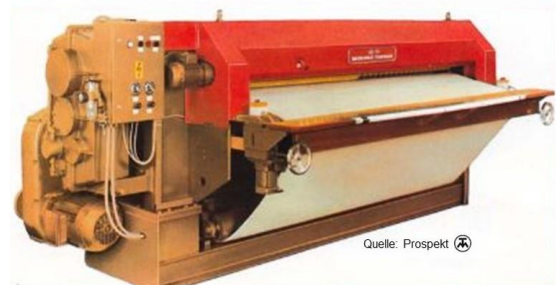
Pneumatische Durchlauf-Abwelkpresse Typ 594 Arbeitsbreiten: 1800 mm, 2800 mm zum Abwelken aller Lederarten in gegerbtem und/oder gefärbtem Zustand
