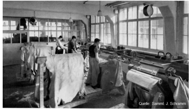
Falzerei mit Turner-Falzmaschinen Nr. 304 Falzmaschine Typ 304 Arbeitsbreite: 450 mm
