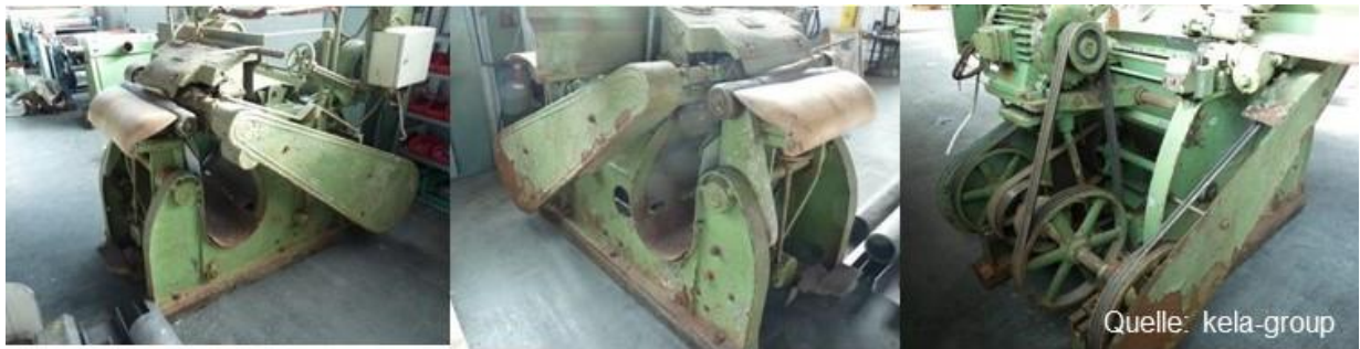
Falzmaschine Typ 304 Arbeitsbreite: 450 mm
