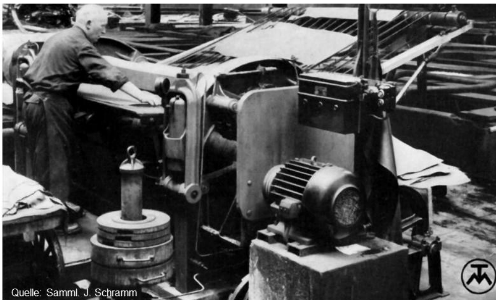
Durchlaufpresse zum Abwelken v. Sohlleder Typ 294
