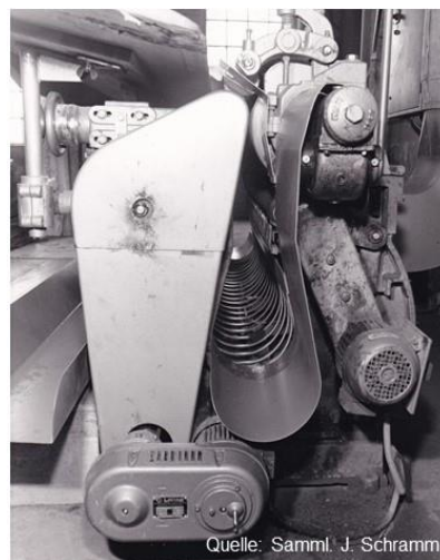
Schleifmaschine Fulminosa Typ 379 Arbeitsbreiten 1200, 1500, 1800 mm
