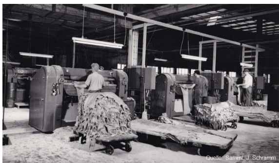
Elektro-hydraulische Durchlauf-Falzmaschinen Typ 540 Arbeitsbreiten 900, 1000 u. 1200 mm
