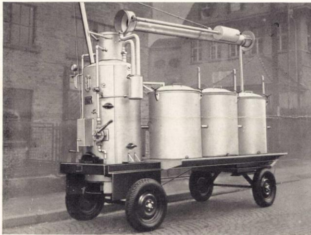
Dämpfkolonne Fig. 12 — auf Transportwagen luftbereit
