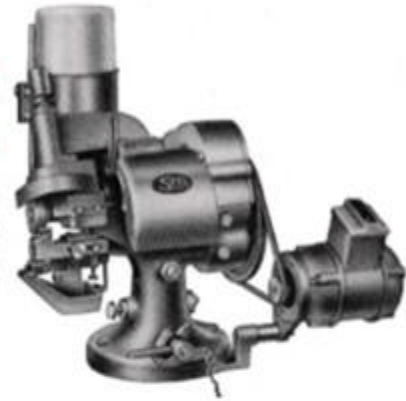
Brandsohlen- Bestreichmaschine Nr.12 für Gumminilch (Latex)
