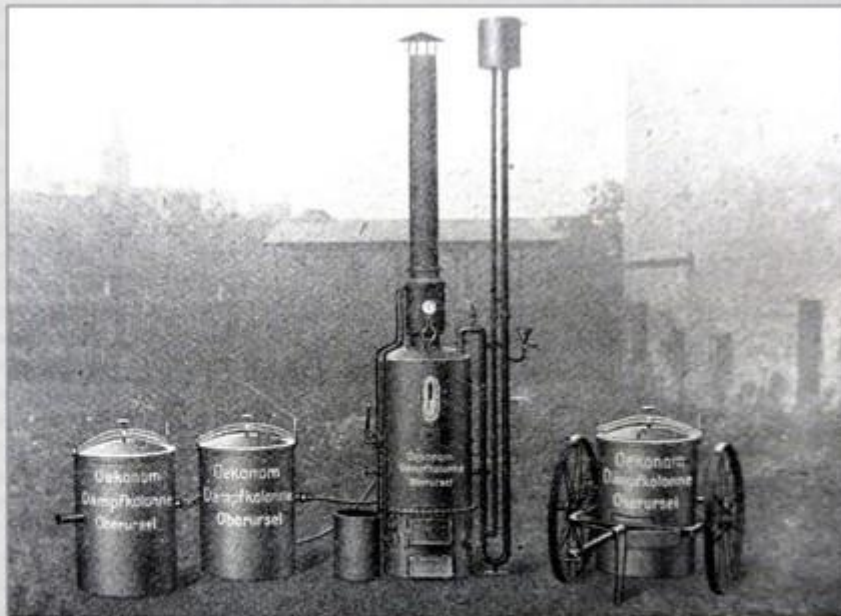
Dekonom = Dampfkolonne der Firma Sabel & Scheurer
