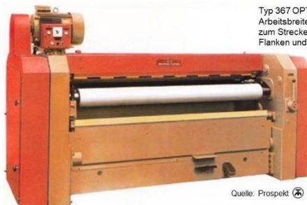
Typ 366 OPTIMA PONTA Arbeitsbreiten: 1800 mm, 2200 mm zum Strecken und Entfleischen von Kalbfellen, leichten Rindhäuten, Häften, Croupons, Hälsen und Schweinhäuten
