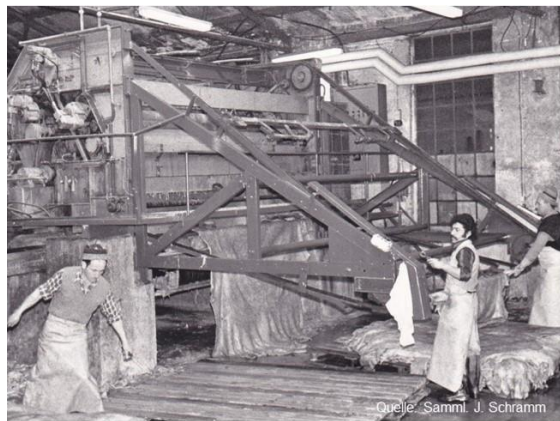
Quelle: Samml. J. Schramm Hydraulische Durchlauf-Entfleisch-Maschine Typ 473 Arbeitsbreite: 3100 mm
