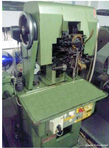
Fulinea Doppelmaschine Schnell-Läufer mit Fotozellensteuerung
