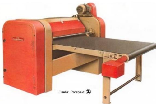
Enthaar- und Entwollmaschine Typ 359 E OPTIMALANORA Arbeitsbreiten: 1450 mm, 1750 mm für alle Kleintierfellarten, bei Bedarf mit zusätzlichem Wollsortierband
