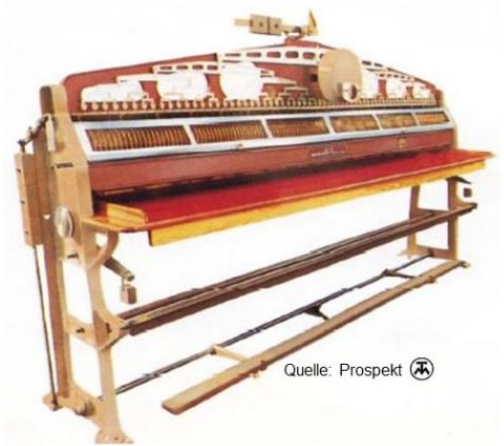
Stiftenrad-Messmaschine PRIMESA Typ 155 Arbeitsbreiten: 1625 mm, 3250 mm
