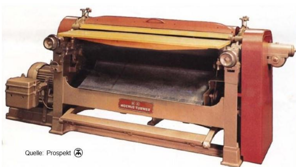
Oszillierende Universal-Schleifmaschine Typ 379 FULMINOSA Arbeitsbreiten: 1500 mm, 1800 mm spezieller Ausstattung für alle Lederarten geeignet, auch als Durchlaufmaschine
