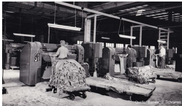
Elektro-hydraulische Durchlauf-Falzmaschinen Typ 540 Arbeitsbreiten 900, 1000 u. 1200 mm
