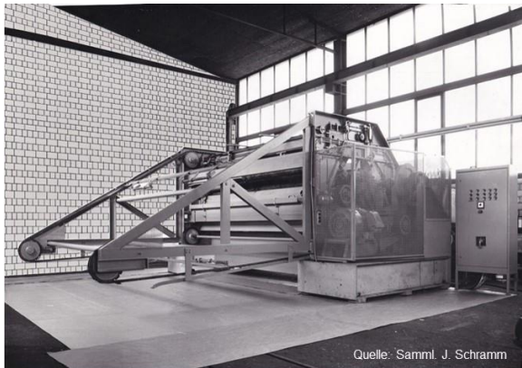
Quelle: Samml. J. Schramm Hydraulische Durchlauf-Entfleisch-Maschine Typ 473 Arbeitsbreite: 3100 mm
