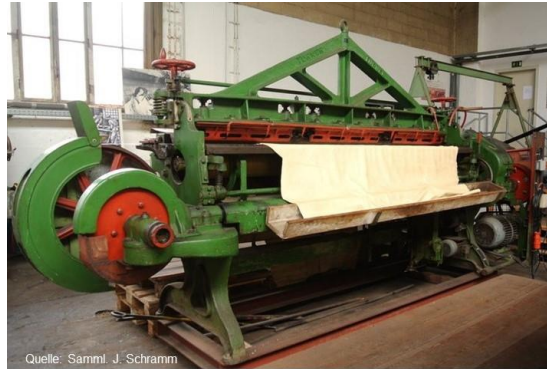
Quelle: Samml. J. Schramm Bandmesser-Spaltmaschine Typ 37 um 1950 H 270 cm, B 480 cm, T 240 cm, Gewicht ca. 4500 kg
