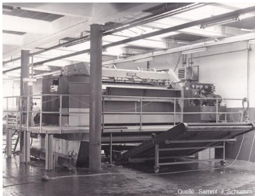
Quelle: Samml. J. Schramm Hydraulische Durchlauf-Entfleisch-Maschine Typ 473 Arbeitsbreite: 3100 mm
