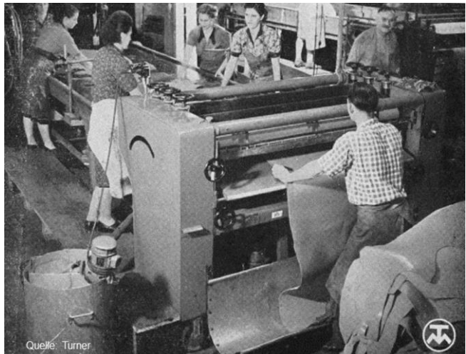
Appretier- und Färbemaschine mit Transportband. Arbeitsbreite 1600 mm
