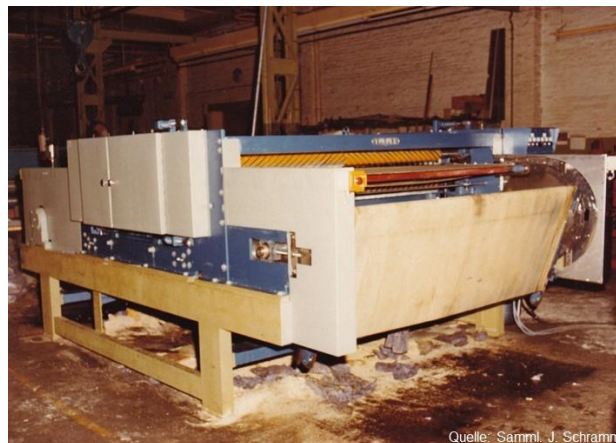
Hydraulische Ausreckmaschine Typ 356 OPTIMA RELLA Arbeitsbreite: 2100 mm zum Ausrecken schwerer Oberleder und Vegetabilleder wie Hälfen, Croupons, Hechte und Hälse
