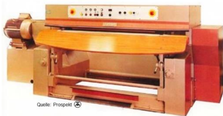
Hydraulische Universal-Falzmaschine Typ 722 D Arbeitsbreite: 1800 mm für ganze Hute, Schweinhute, Halfen und Croupons, mit Nachstellautomatik und Einfahrsicherung
