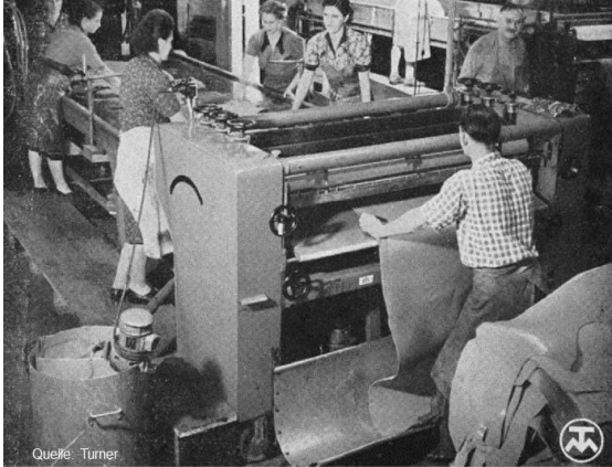
Appretier- und Färbemaschine mit Transportband. Arbeitsbreite 1600 mm
