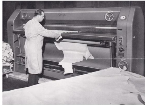
Enthärtungsmaschine Bauj. 1965 Fa. Turner
