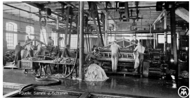
Wasserwerkstoff mit Turner-Spaltmaschinen Nr. 37 Bandmesser-Spaltmaschine Typ 37 um 1950 H 270 cm, B 480 cm, T 240 cm, Gewicht ca. 4500 kg
