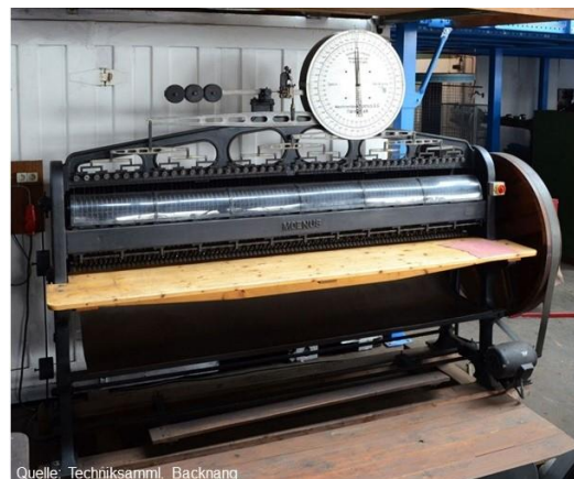
Stiftenrad-Flächenmessmaschine von Turner um 1940 Arbeitsbreite 2440 mm
