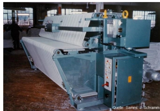
Hydraulische Durchlauf-Vibrations-Stollmaschine Typ 530 Arbeitsbreiten: 1600mm, 2400mm, 3200mm geeignet für alle Lederarten
