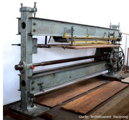
Bügel- und Narbenpresse Altera um 1938 B 510 cm, H 200 cm, T 175 cm; Gewicht 3100 kg
