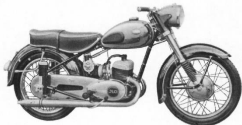
Bücker Ilona II, 2 Zylinder, Hinterradfederung, staubdichter Kettenkasten, Bauj. 1953
