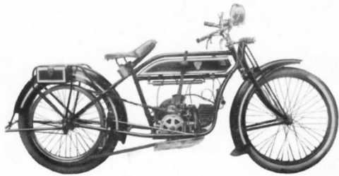
Bücker FBO, 150 ccm, 4 PS, mit „Becamo“-Motor, Kompressor, Baujahr 1924
