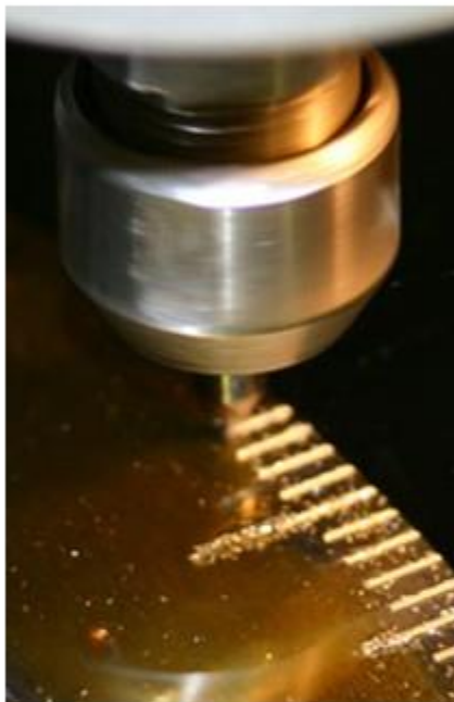
Gravur auf Rundachse, Skalen für Messinstrumente oder Werkzeugmaschinen
