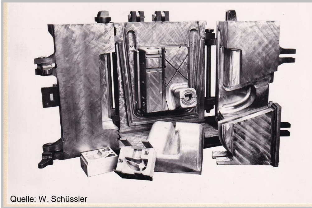
Stahl-Kokille f. Schneidmaschine Alu.-Abguß m. Croningkern
