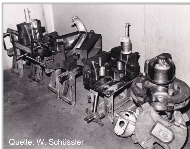
Kokille-Einrichtungen zu Ventiltopf.Kuppl.-Gehäuse, Zylinder-Kopfhaube u. Wanne
