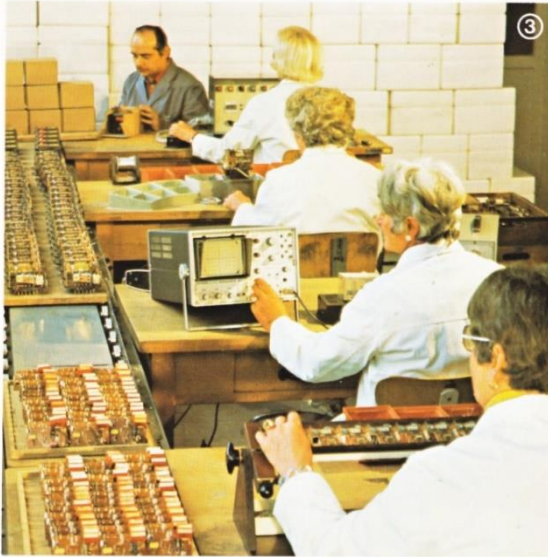
③ Endmontage von Öl- und Gasfeuerungs-Steuergeräten. Final assembly of control apparatus for oil and gas burners.
