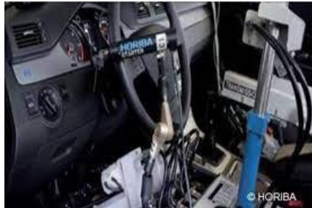
PKW mit Fahrerroboter auf dem Rollenprüfstand
