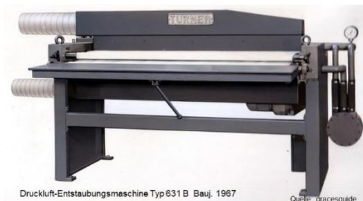
Druckluft-Entstaubungsmaschine Typ 631 B Bauj. 1967
