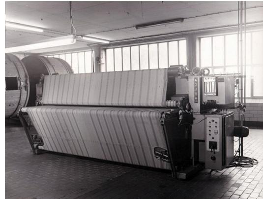
Hydraulische Durchlauf-Vibrations-Stollmaschine Typ 530
