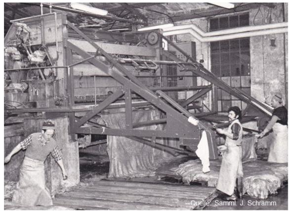
Hydraulische Durchlauf-Entfleisch-Maschine Typ 473 Arbeitsbreite: 3100 mm
