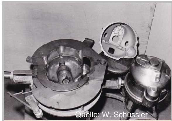
Dauergußform – Kokille zu Kupplungsglocke
