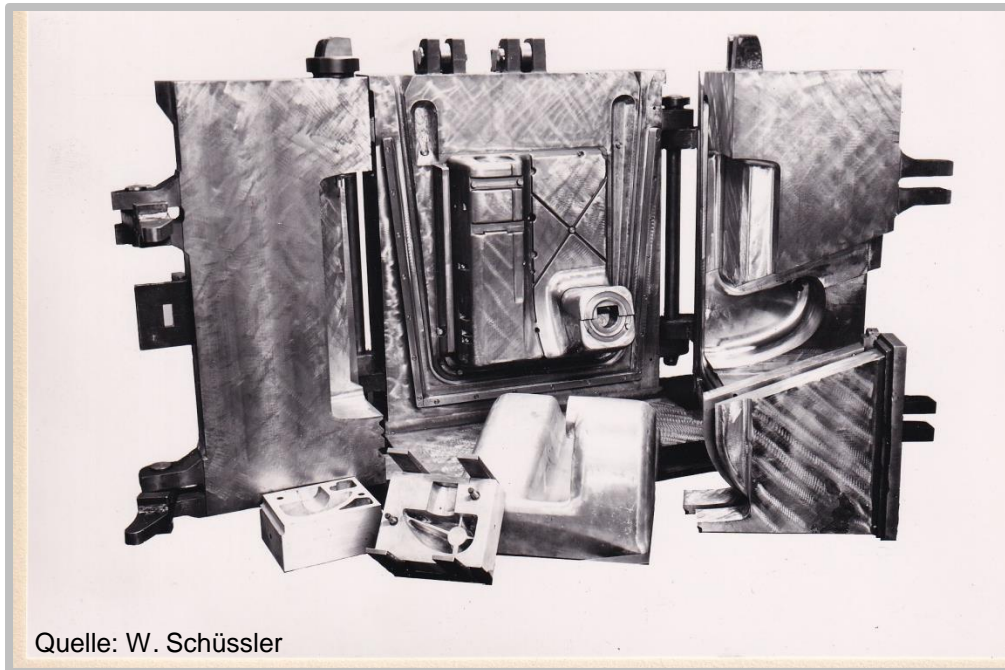
Stahl-Kokille f. Schneidmaschine Alu.-Abguß m. Croningkern
