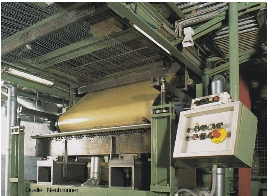
Fadenleger mit 1.250 mm Arbeitsbreite
