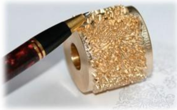
Signiersysteme Gravur auf Rundachse, Messing-Prägewalze für Verzierung auf Schmuckbändern
