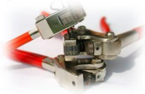
Signiersysteme Gravur auf Rundachse, Messing-Prägewalze für Verzierung auf Schmuckbändern
