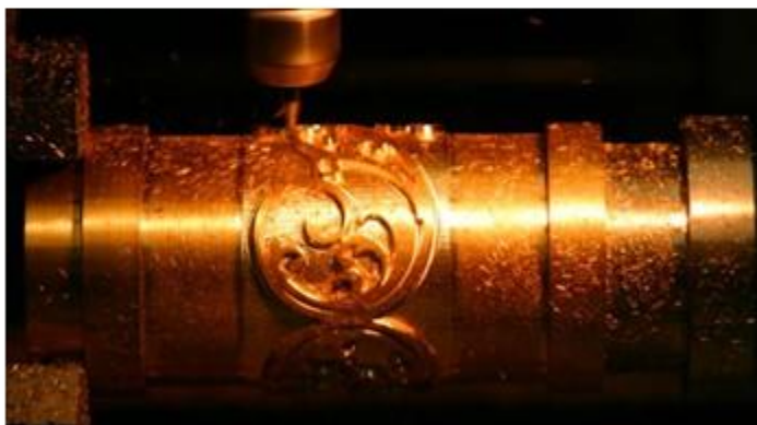
Gravur auf Rundachse, Messing-Prägwalze für Zierprägung auf Schmuckbändern
