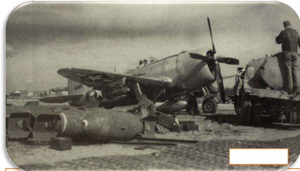
P-47 Thunderbolt, mit Rumpf-Zusatztank, bei der Einsatzvorbereitung Geschwindigkeit 560 km/h (Reise), bis 680 km/h max.; 6 Maschinengewehre 12,7 mm; bis zu 1000 kg Bomben, z. B. zwei 1000-Pfund-Bomben
