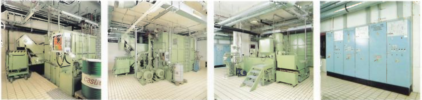
Ein Unterdruckfilter FUF zur Reinigung von Emulsion bei einem Hersteller von Spiralbohrern: Filterfläche 2,1 m 2 (rechts unten).
