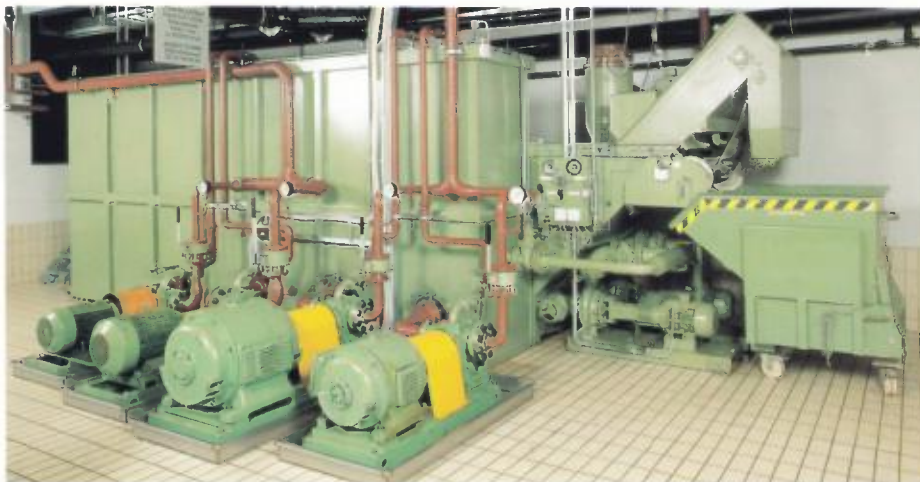
Ein Unterdruckfilter FUF zur Reinigung von Emulsion bei einem Hersteller von Spiralbohrern: Filterfläche 2,1 m 2 (rechts unten).
