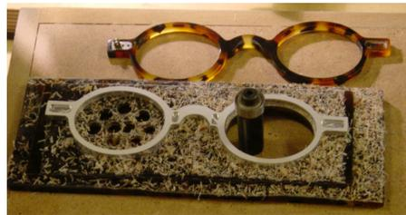
Im nächsten Schritt wird das Scharnierbett und die Nut für das Glas gefräst
