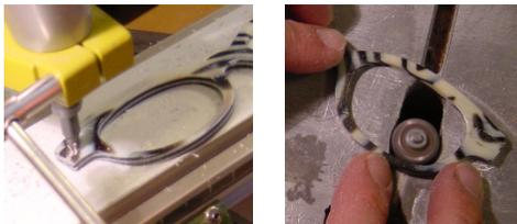
Dann werden die Scharniere in die Fassung und die Bügel vernietet
