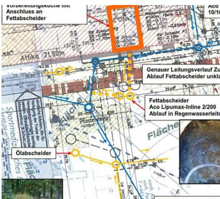
Gemäß Auftrag eines nationalen Sportverbandes wurden eine Bestandsdatenerfassung und ein Beweissicherungsverfahren an bestehenden Entwässerungssystemen durchgeführt. Einer der Hauptaspekte war hierbei die fachtechnische Prüfung der Anschlüsse von Fettabseidern und integrierten Zisternen im Hinblick auf die ordnungsgemäße Bauausführung und Dimensionierung. Systemkomponenten wie großdimensionierte Versickerungsgruben wurden vermessen und bzgl. der jeweiligen Versickerungsleistung verifiziert.
