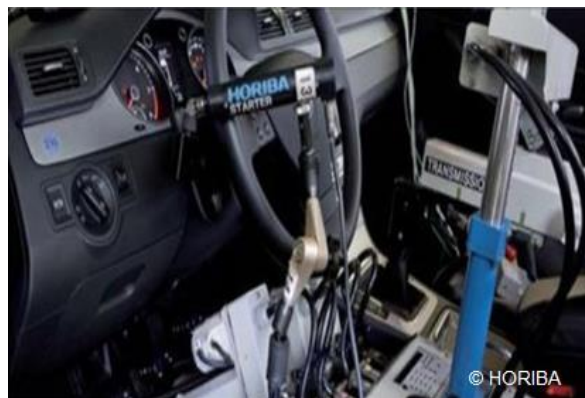
PKW mit Fahrroboter auf dem Rollenprüfstand
