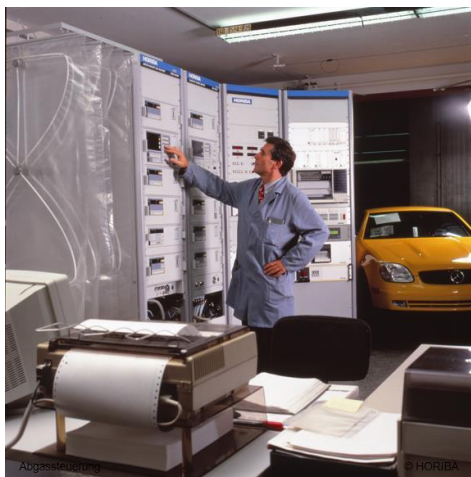
TestCenter: Prüfstandsteuerung – Schalt- und Bedienungszentrale (alt)
