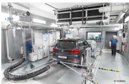
Testfahrzeug auf dem Rollenprüfstand
