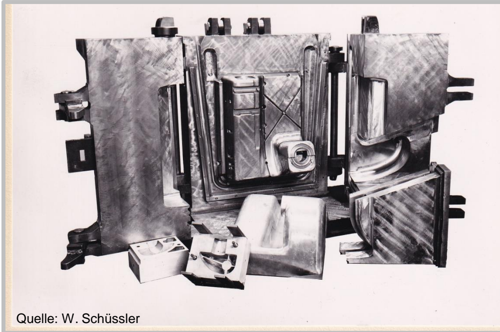
Stahl-Kokille f. Schneidmaschine Alu.-Abguß m. Croningkern
