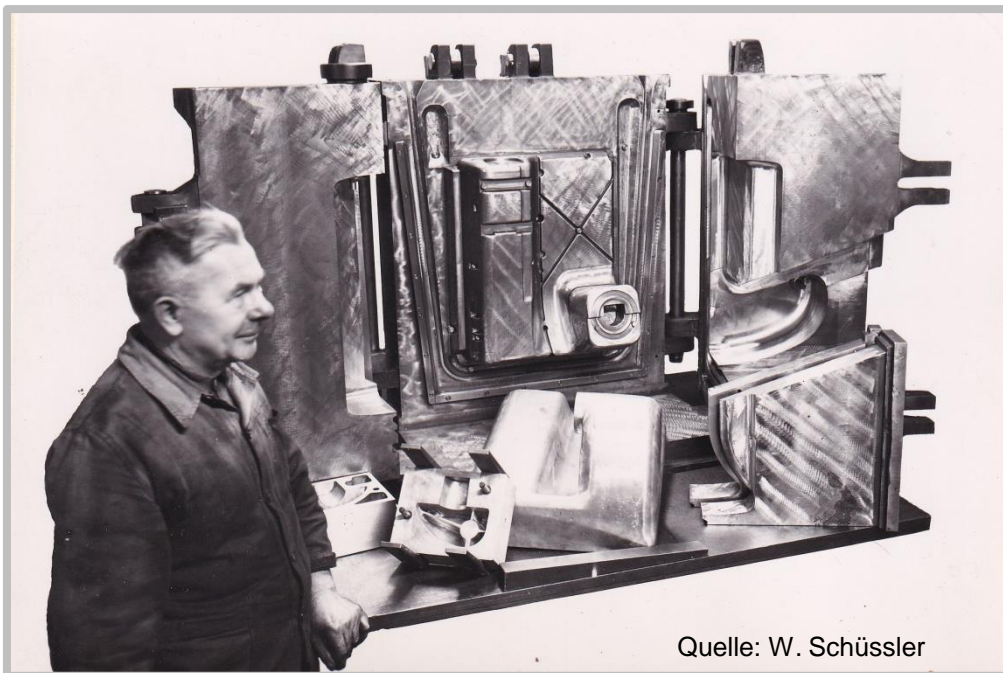
Stahl-Kokille f. Schneidmaschine Alu.-Abguß m. Croningkern
