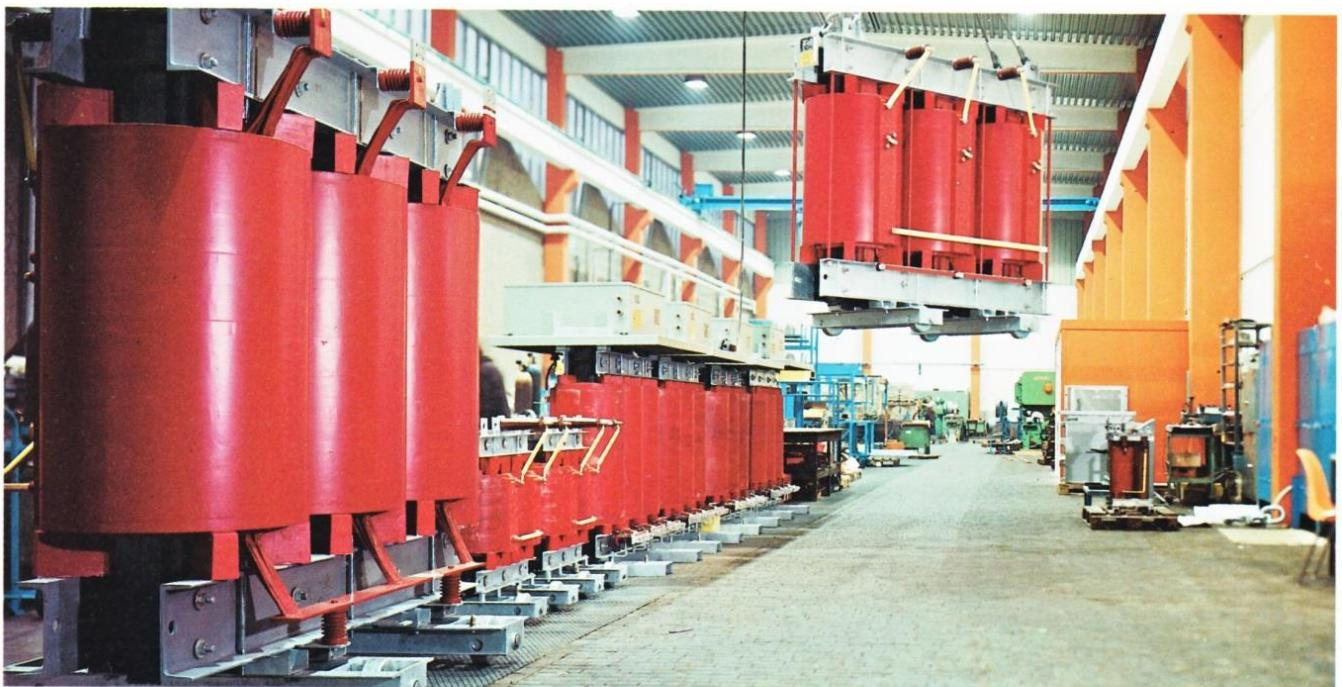
MAYLAMID-Leistungstransformatoren haben seit 20 Jahren immer breitere Anwendungsgebiete erschlossen, weil sie keine brennbaren Kühlflüssigkeiten benötigen und dennoch bessere oder gleichwertige elektrische Qualitätsmerkmale aufweisen als Oltransformatoren. Ihre Stoßkurzschluß- und Stoßspannungsfestigkeit ist hervorragend.
