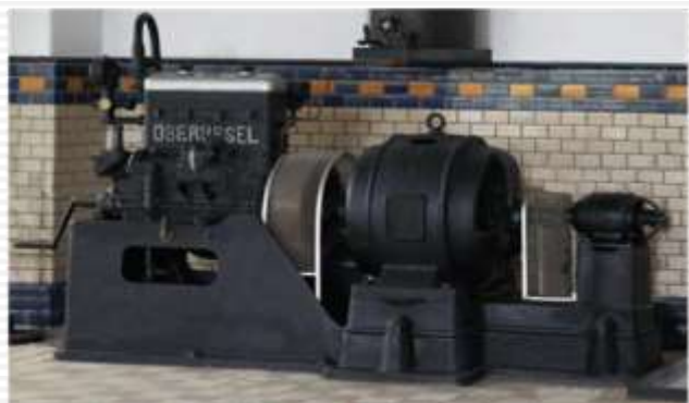
Motor Modell 35 (LM116) im Werksmuseum und als Generatorantrieb im alten Wasserwerk in Hattersheim
