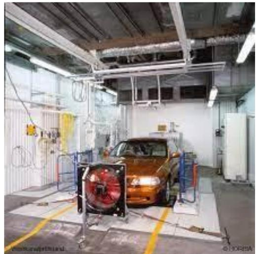
Rollen und Windkanalprüfstand
