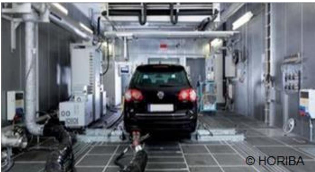
PKW auf dem neuen Rollenprüfstand
