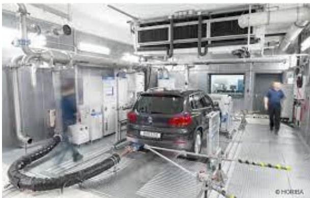
Testfahrzeug auf dem Rollenprüfstand
