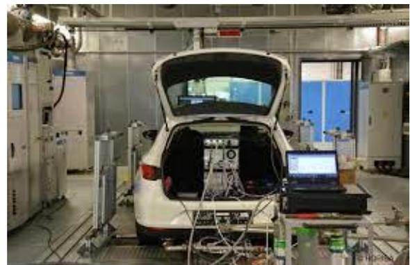
Testfahrzeug auf dem Rollenprüfstand
