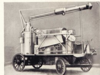
Dampfkolonne Fig. 12 auf Transportwagen mit Holzrädern
