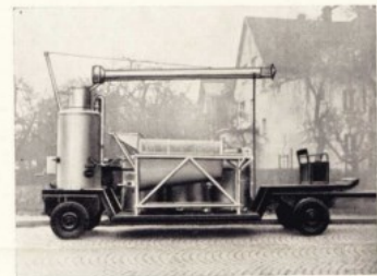
Dampfkolonne Fig. 12 auf Tieflader luftbereit
