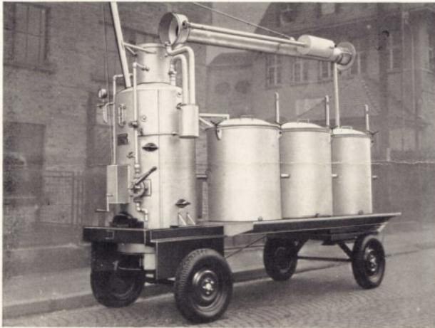
Dampfkolonne Fig. 12 — auf Transportwagen luftbereit
