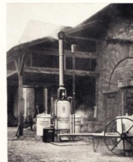
Dämpfkolonne Fig. 1 bei der Arbeit
