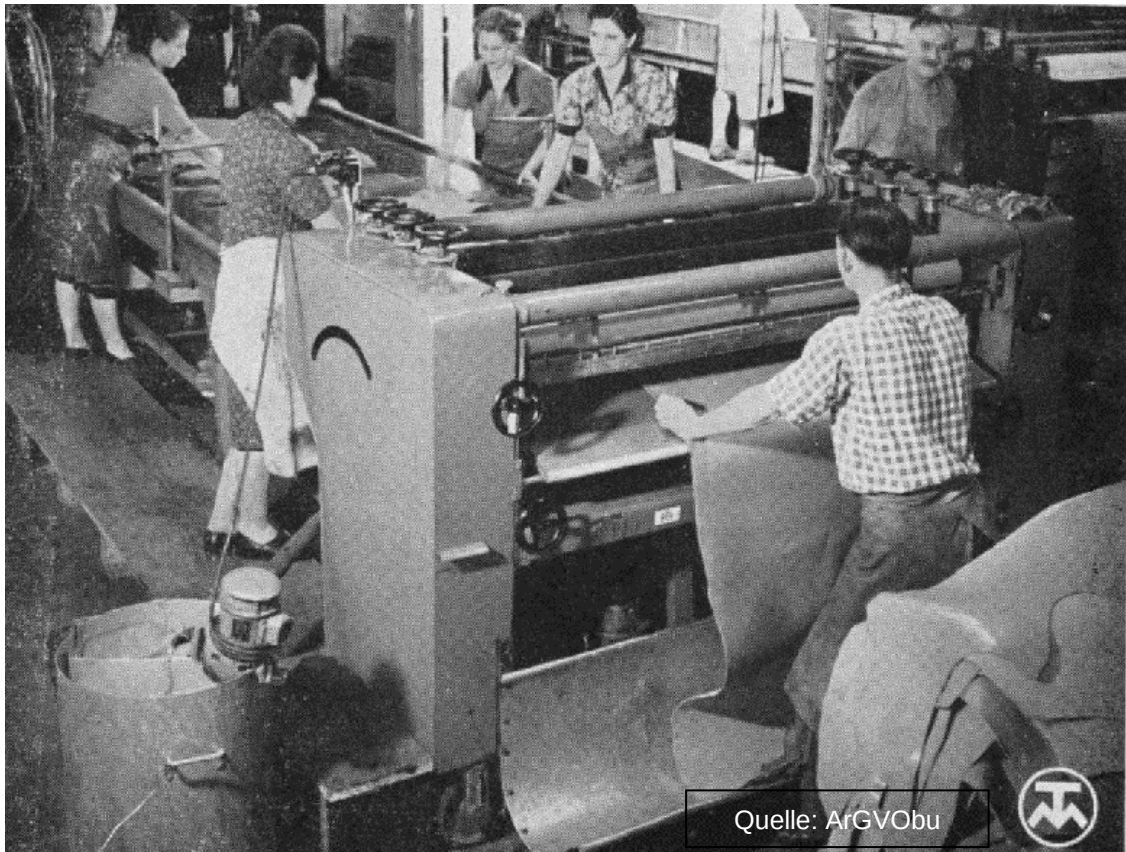
Abretier- und Färbemaschine mit Transportband. Arbeitsbereich 1600 mm
